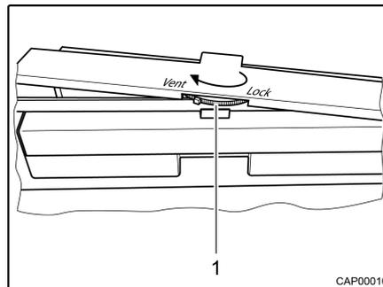
Bild 54 Verriegelung Kühlschranktür
