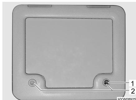
Bild 68 Klappe für den Fäkalientank
