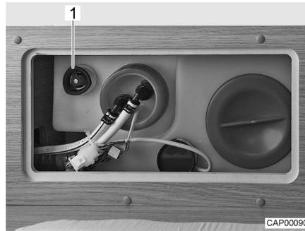
Bild 59 Wassertank mit Drehgriff
